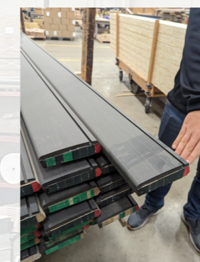
削られて下塗装されたレール
