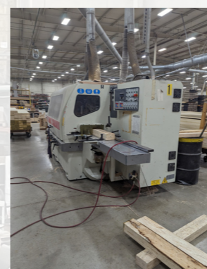
この機械で先程のレール部材をレールの形に削っていく
