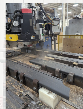
次にCNCマシンによってポケットの入り口や各部が削られていく。テーブルの他の部品もこのマシンで加工される
