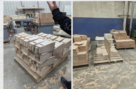
脚を組み立て工程。カットは機械が行うが、組み立ては全て手作業で非常に時間がかかる工程
